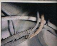
Kraftstoffleitung: Rotbraun blüht der Rost am spritzelnden Rohr
