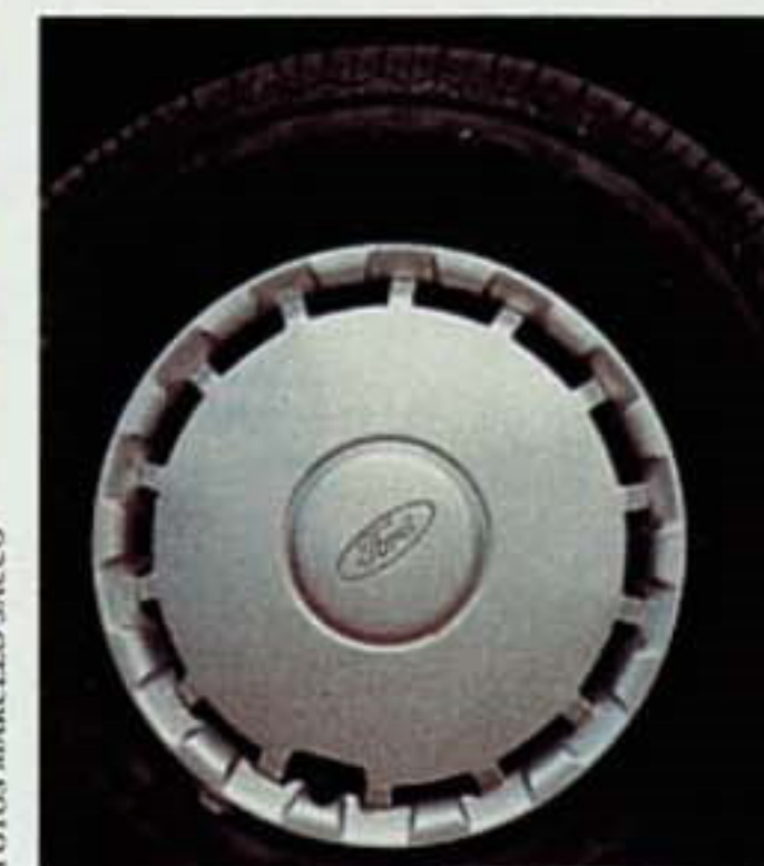
Rodas de aço, nos dois modelos. Mas as do GL (abaixo) vêm com calota plástica
