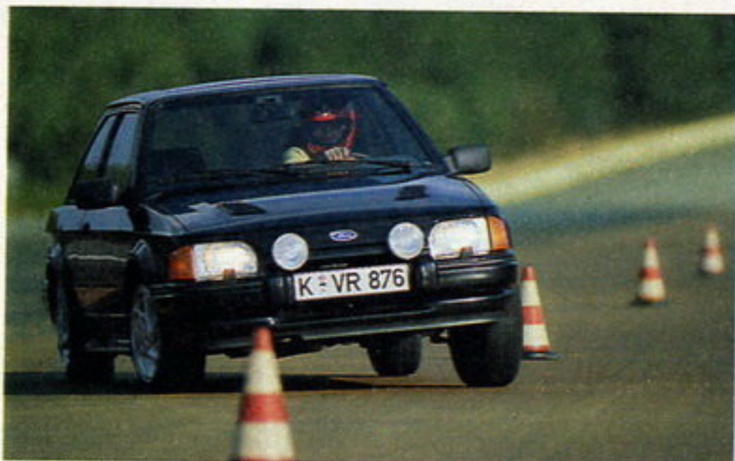
Beim Einlenken erfordert der Escort extrem hohen Kraftaufwand.
