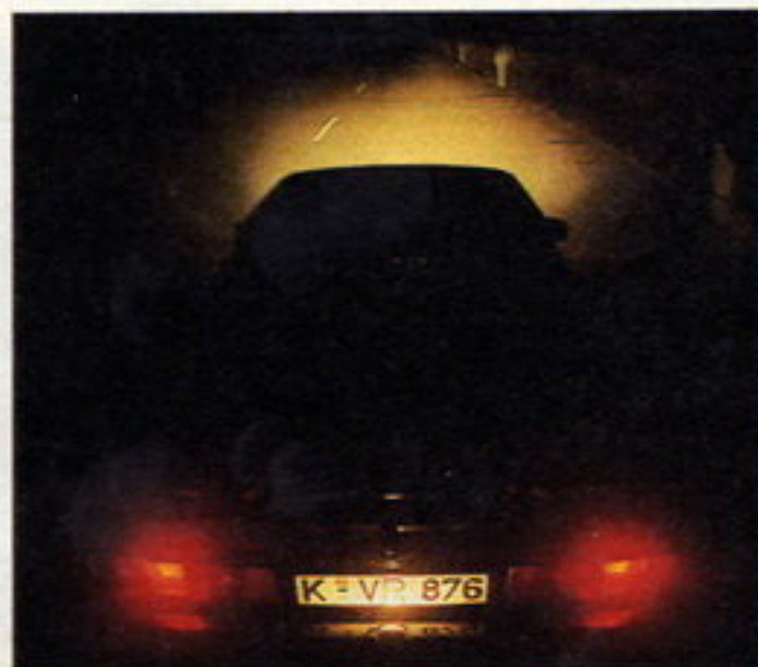
Ford Escort: Gleichmäßiges Abblendlicht, gutes Fernlicht dank Zusatzscheinwerfer.
