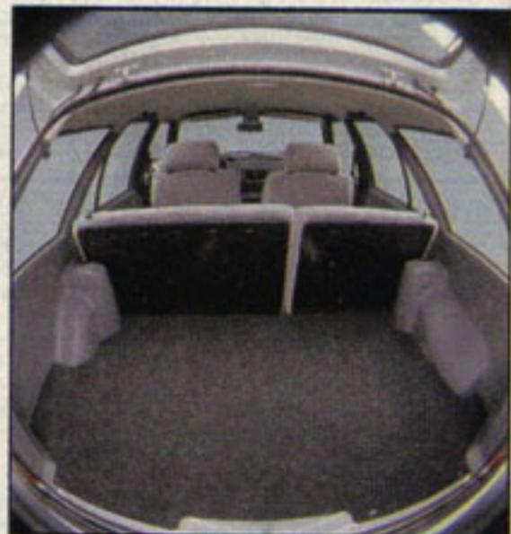
Sulla «Escort Station» si possono caricare da 360 dm<sup>3</sup> di bagaglio nella configurazione dei sedili per 4-5 posti fino a un massimo di 1200 dm<sup>3</sup> con l'intero schienale (sdoppiabile) del sedile posteriore abbattuto.
