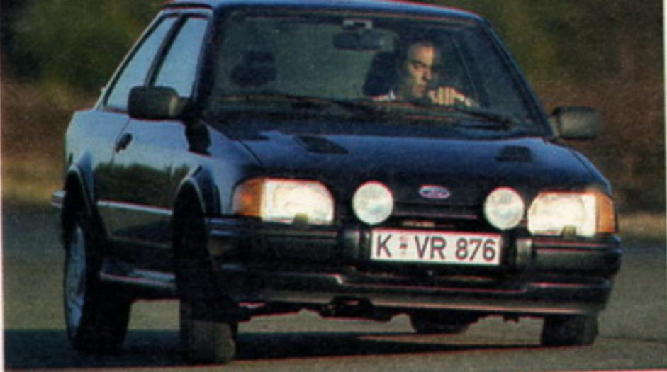
Dank Visco-Sperre verfügt der Escort über gute Traktion. Er untersteuert im Kurvengrenzbereich.
