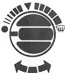
Unabhängig von der Stellung des Luftverteilungs-Drehschalters ist Luftaustritt aus den Mitteldüsen und den Seitendüsen immer möglich.
