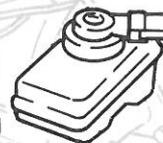
Die Funktion der Warnleuchte ist (bei eingeschalteter Zündung) durch Druck auf den schwarzen Knopf am Nachfüllbehälter von Zeit zu Zeit zu prüfen.
