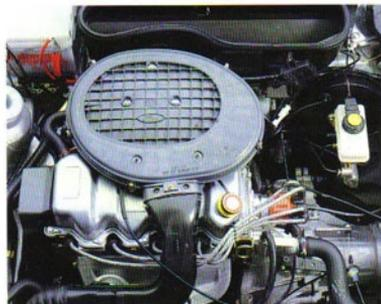
Der 1,4-Liter-CVH-Einspritzmotor, 54 kW (73 PS), mit geregelttem Katalysator. Er erfüllt die strenge 83er-US-Abgasnorm.
