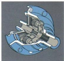
Viscogekuppeltes, selbstsperrendes Differential
