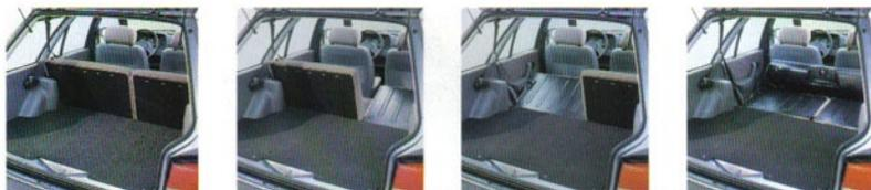
Die zu 1/3, 2/3 oder ganz umklappbare Rücksitzlehne (bei Modell C nur ganz umklappbar) ermöglicht auch größere Transporte
