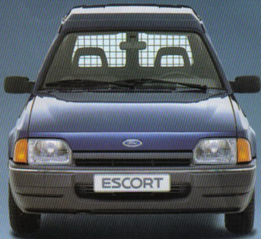
*Im Windkanal entstand sein markantes Gesicht mit weit herunterreichender Motorhaube und integriertem Frontspoiler.*
