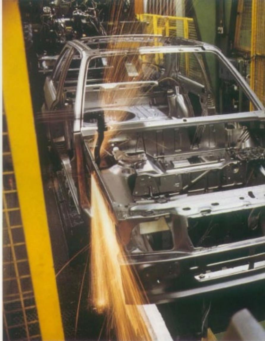
Präzisions-Roboter für punktgenaues Schweißen.
