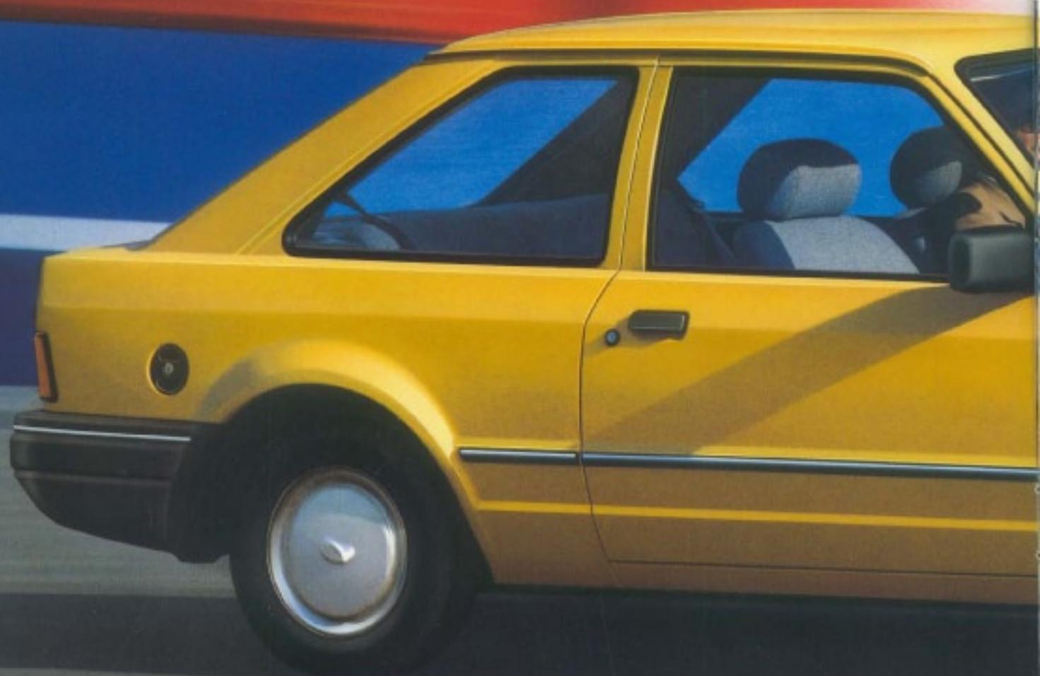
ab. Die gesamte Frontpartie wird seitlich bis zu den Radausschnitten von einem neuen Kunststoff-Stoßfänger-System geschützt. Für den beim Parken in engen Parklücken oft nötigen Flankenschutz sorgen Seitenschutzleisten aus PVC. In die Heckpartie des Escort ist ebenfalls ein weit um die Ecken herumreichender Kunststoff-Stoßfänger integriert. Dezent und ganz und gar nicht aufgesetzt: der Spoiler in der Hecktür.
