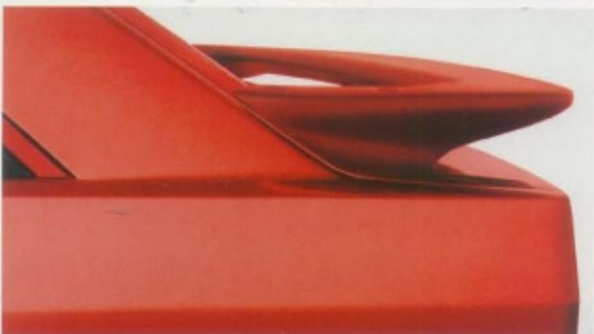
Der markante Heckspoiler sorgt für den nötigen Anpreßdruck.
