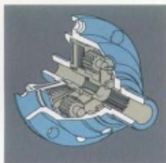
Viscogekuppeltes, selbstsperrendes Differential
