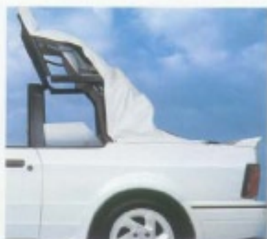
In Windeseile „oben ohne“ – mit dem serienmäßig elektrischen Schnelfaltverdeck.
