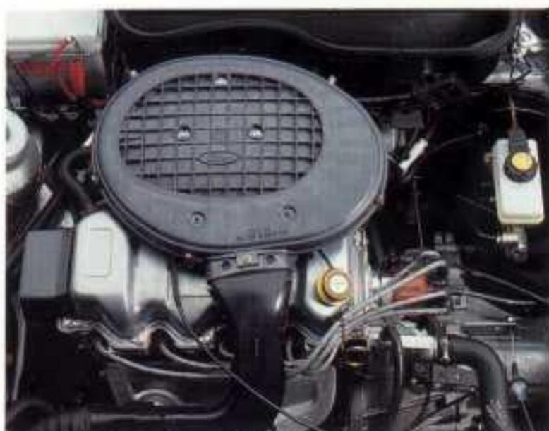
*Der 1,4-Liter-CVH-Einspritzmotor, 54 kW (73 PS), mit geregelter Katalysator. Erfüllt die strenge 83er US-Abgasnorm.*
