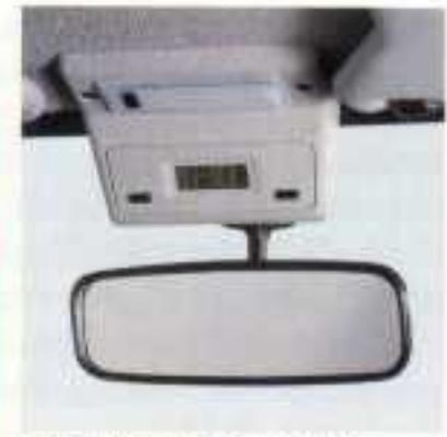
Digitaluhr in der Dachkonsole
